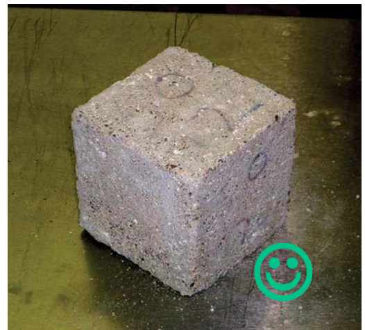
Béton 50 % ciment Portland + 50 % Ecocem classe A après 28 jours dans du jus d'ensilage
