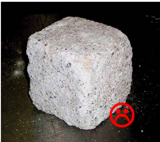
Béton 100 % ciment Portland après 28 jours dans du jus d'ensilage
